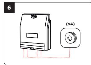
Glissez les passe-fils de l'électronique sécurisée et passez les fils. Faites vos branchements. Lors de cette opération, n'oubliez pas de placer la varistance (Voir page 15 «Rappels et recommandations»).
