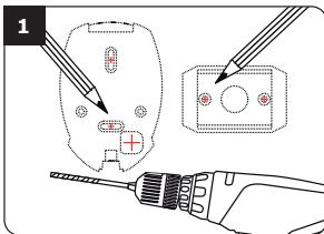
Vérifiez la distance entre le GALEO et son électronique sécurisée (Voir page 15 «Rappels et Recommandations»). A l'aide de la plaque de fixation de l'électronique sécurisée et du GALEO, prenez les marques et percez les 2 trous de fixation (forêt Ø 5 mm et profondeur minimum = 35 mm) ainsi que l'ouverture pour le passage du câble électrique destiné au clavier.
