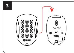
Passez le câble électrique du GALEO dans son ouverture et fixez-le à son support par le haut avec le crochet supérieur.
